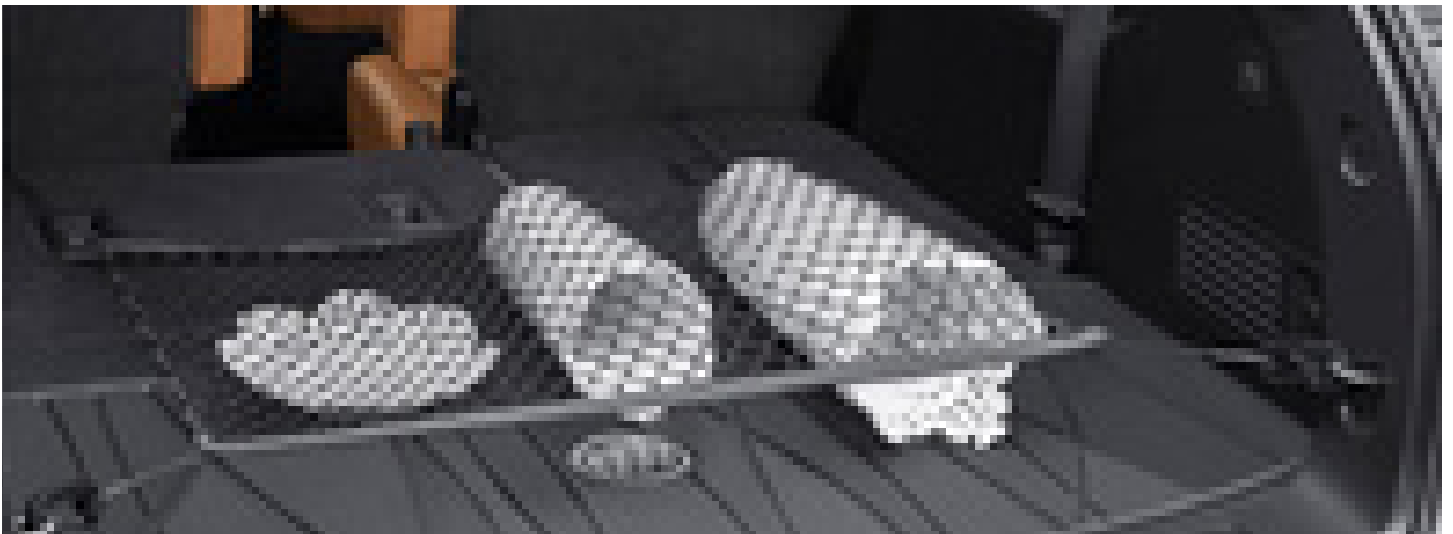
Red horizontal para área de carga
