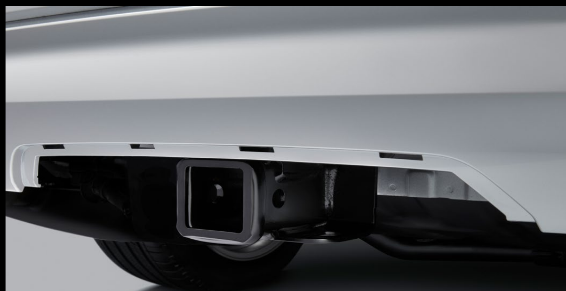
SISTEMA DE REMOLQUE CON ENGANCHE DE 1,500 LB DE CAPACIDAD
