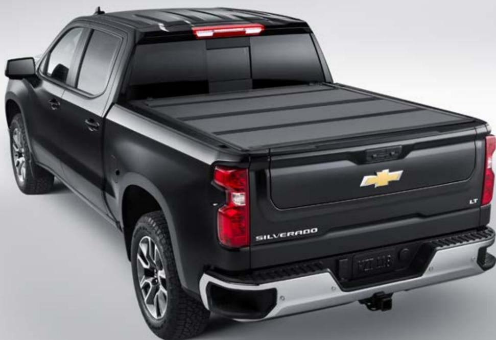
Cubierta rígida tri-fold
