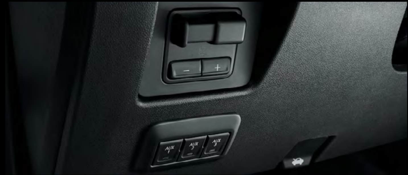
Interruptor de kits de iluminación
