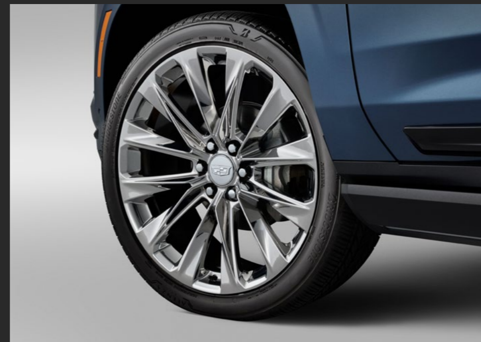
RIN DE ALUMINIO DE 24 X 9.5 PULGADAS Y 6 RADIOS DIVIDIDAS EN COLOR PLATEADO
