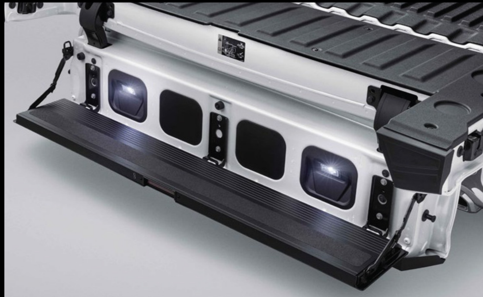
Iluminación del escalón de la puerta de caja
