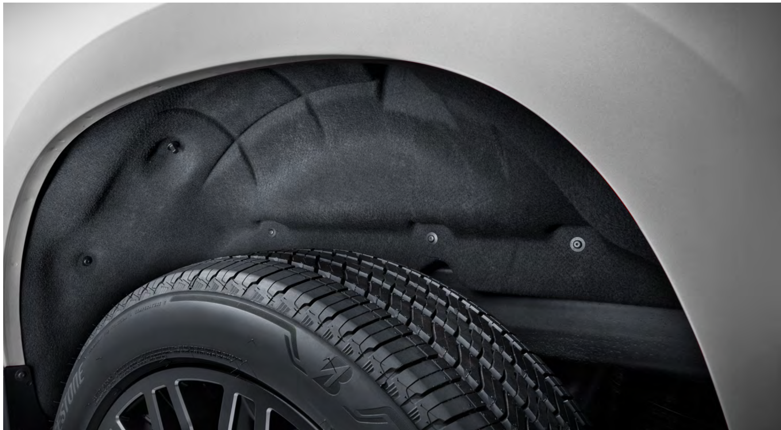
Cubierta de tolva
